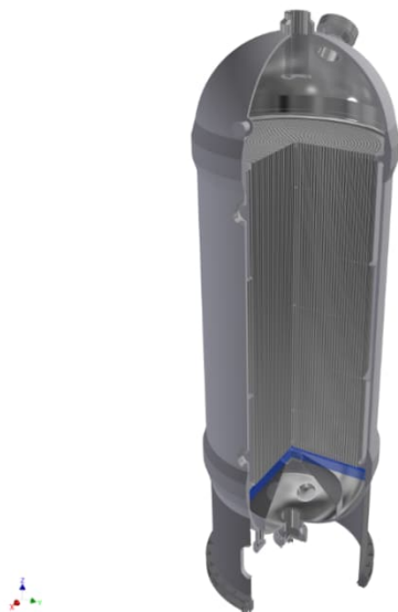
Figur 8. Illustration av reaktor för framställning av e-metanol ur vätgas och koldioxid. Illustration: Haldor Topsoe.
